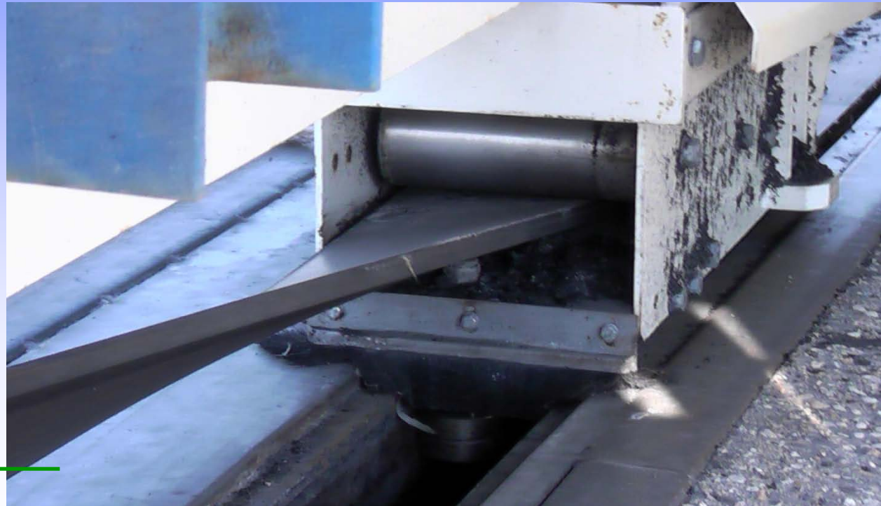
Lyra alzanastro in funzione: nastro sollevato con azione elastica
